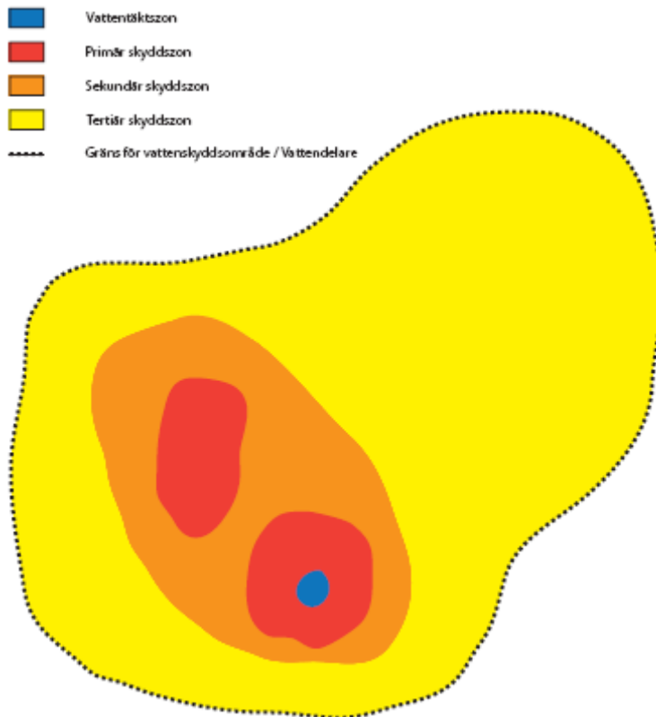
Fig. 4.3 Principskiss för avgränsning av vattenskyddsområde för grundvattentäkter och indelning i skyddszoner där gräns för vattenskyddsområde sammanfaller med vattendelaren.
