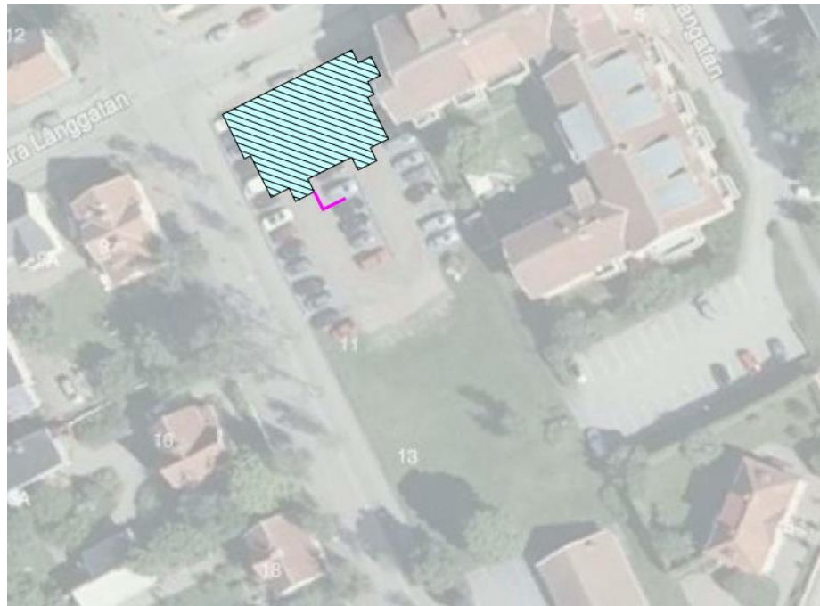
Figur 5. Illustration av lämpliga åtgärder för att innehålla riktvärden, lila markering visar var bullerskydd bör placeras.
