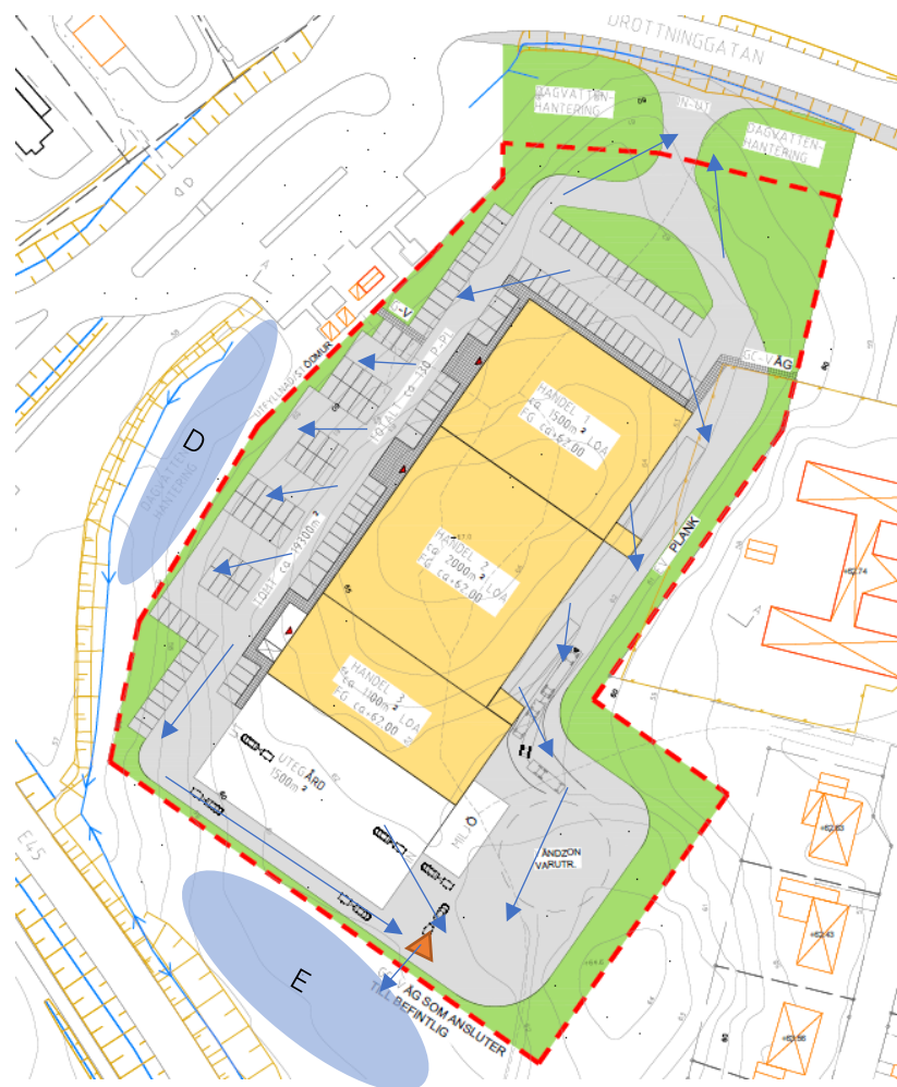
Figur 17. Förslag 2: Dagvattnet leds till södra delen av området via ledningsnätet. Dagvattnet transporteras sedan vidare till dagvattendammar placerade i nordväst och sydväst. Blåa pilar visar avledning över mark.
