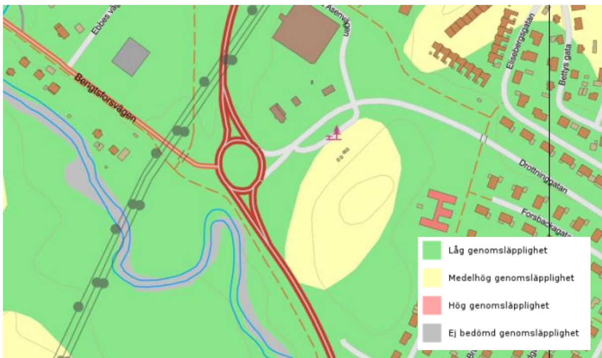
Figur 5. Topografiskt underlag som visar den genomsnittliga genomsläppligheten. © Lantmäteriet, 2022.
