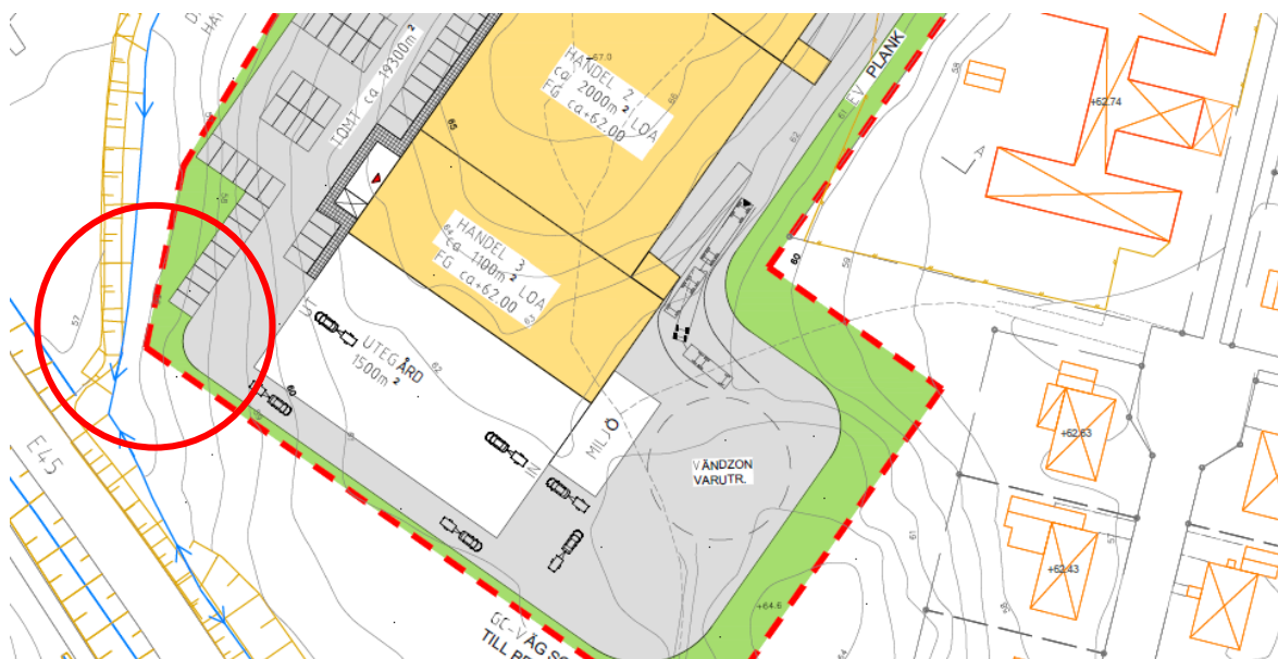
Figur 15. Stora skillnader i höjd i förhållande till vattengångarna i 2000 trummorna. Resulterar i att höga murar behöver anläggas.
