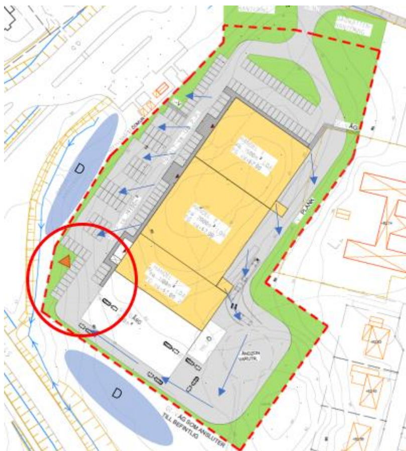
Fig.24 Illustration som visar dagvatten och skyfallshantering i området. Områden markerade med D visar område för skyfallshantering, bild hämtad från Dagvattenutredningen (Pontarius 2022-10-25).
