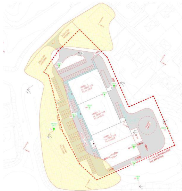
Fig.12 Gult område markerar delar av området där lösare jordmaterial förväntas förekomma. Norconsult 2022.
