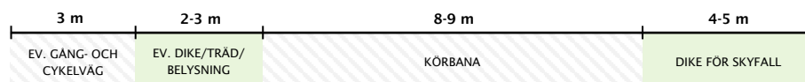
Figur 13 – Illustration på tänkbar gatusektion för den nya gatan med vändplats i industriområdet. Gatuområdet är totalt 19 meter brett.
